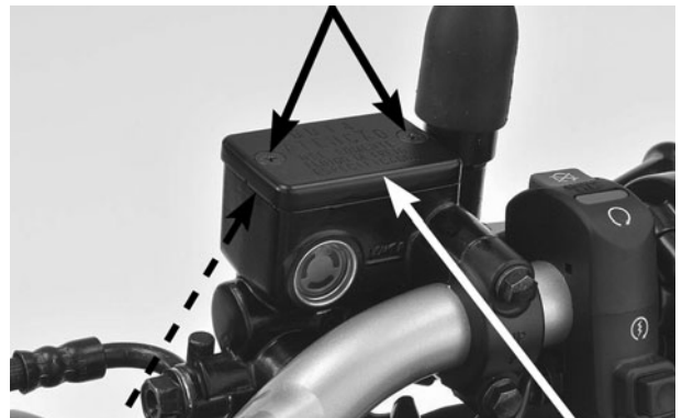
PLACA E DIAFRAGMA TAMPA DO RESERVATÓRIO VÁLVULA DE SANGRIA SUPERIOR
