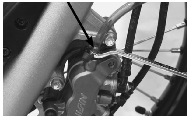
PLACA E DIAFRAGMA TAMPA DO RESERVATÓRIO VÁLVULA DE SANGRIA SUPERIOR
