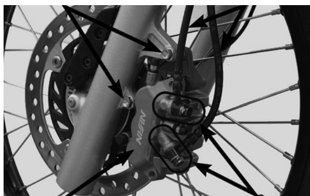
CÁLIPER PARAFUSOS DO ÓLEO E ARRUELAS DE VEDAÇÃO
