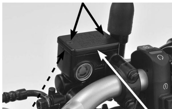
DIAFRAGMA E PLACA DE FIXAÇÃO TAMPA DO RESERVATÓRIO VÁLVULA DE SANGRIA INFERIOR
