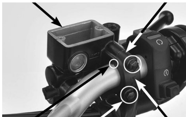
Alinhe PARAFUSOS MARCA "UP" PINO PARAFUSO DO ÓLEO
